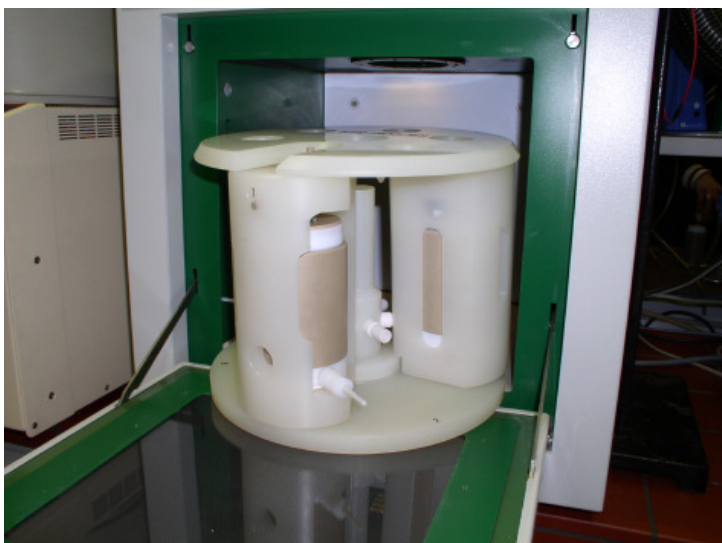
Figura 2 - Assemblaggio di tre reattori per l'estrazione/filtrazione in un rotore alloggiato nel forno a microonde ETHOS 1600
