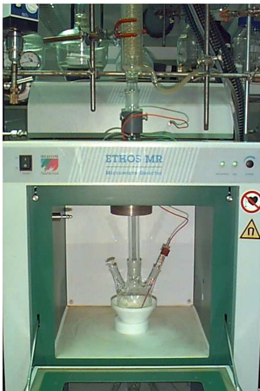
Forno a microonde ETHOS MR dotato di apparato per il reflusso
