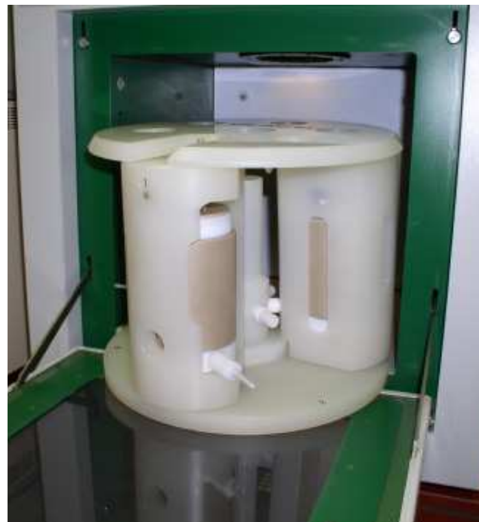
Assemblaggio di tre reattori per l'estrazione/filtrazione in un rotore alloggiato nel forno a microonde ETHOS 1600
